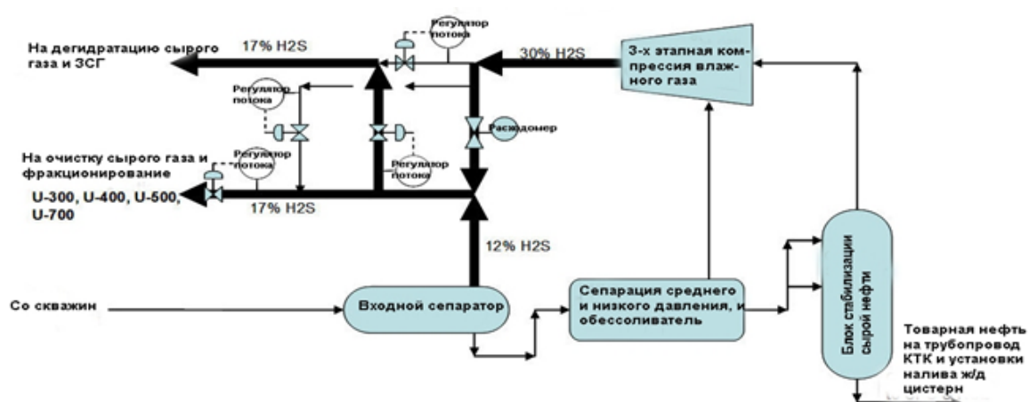
Рис. 2.5 – Схема базового варианта закачки сырого газа
